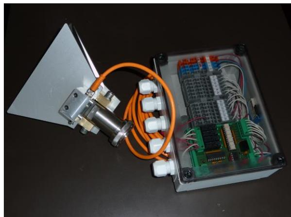
Satz Diffuser mit Detektor und elektronische Steuereinheit
